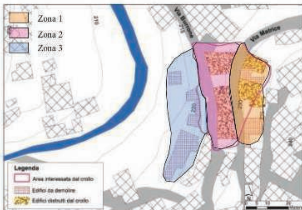
Figura 16 Edifici per cui è prevista la demolizione
