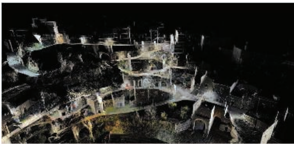
Unione delle scansioni - nuvola texturizzata
