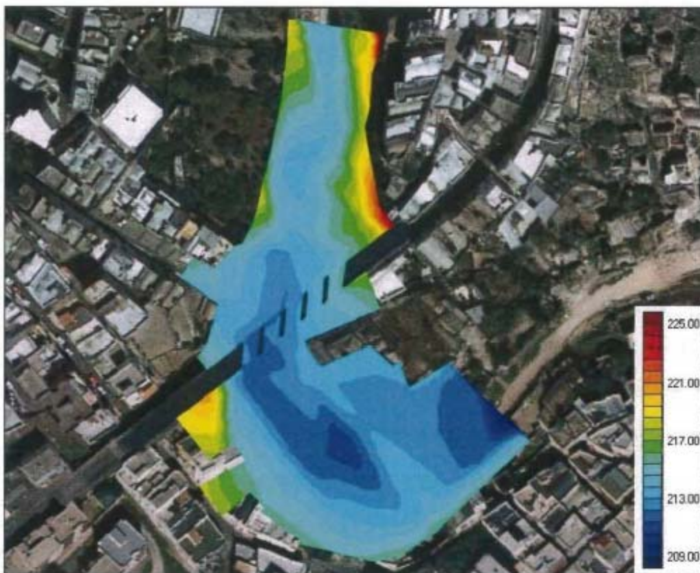
Figura 27: Tiranti idrici del ponte SS580-GINOSA ottenuta dal modello di D'Alpaos
