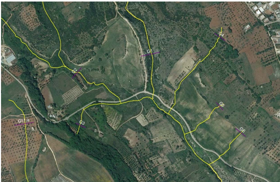
Figura 18: Inquadramento delle sezioni di inserimento delle portate di piena
