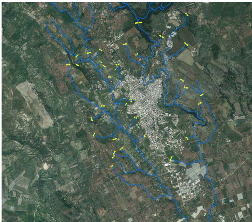
Figura 1.4: Indicazione delle BC in giallo inserite nel modello
