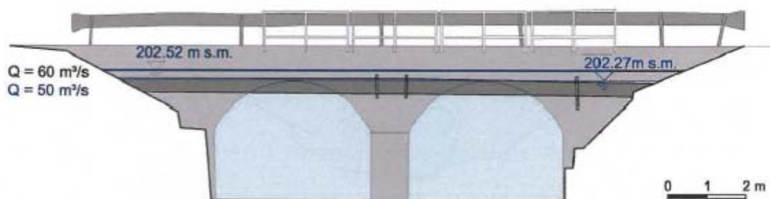
Figura 23: Sezione del ponte della SP1 ottenuta dal modello di D'Alpaos
