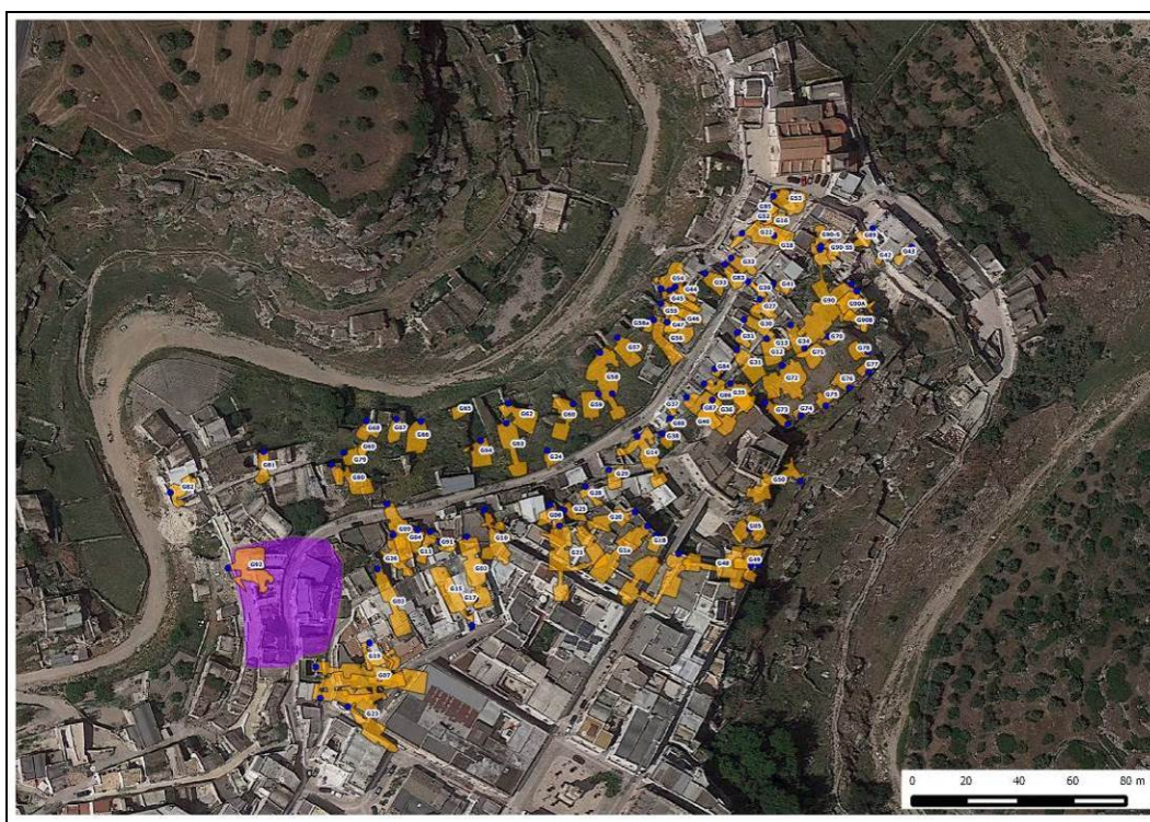
Fig. 34: Cavità antropiche rilevate dal CNR-IRPI
