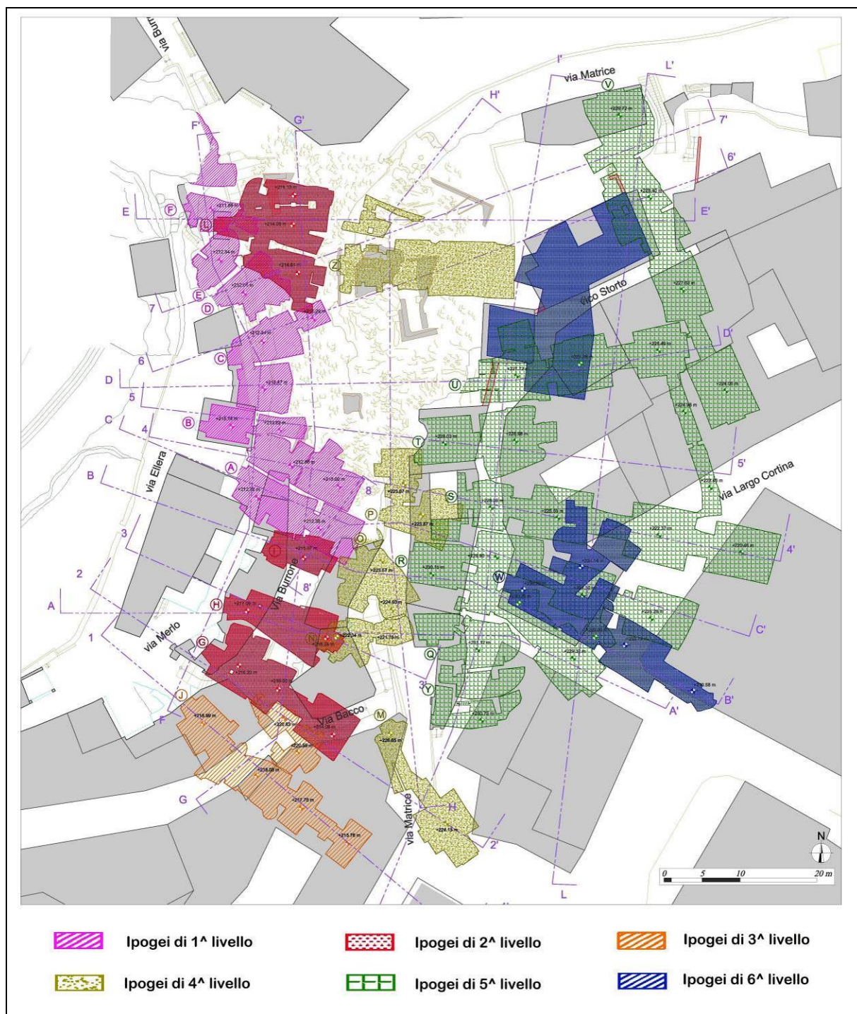
Fig. 36: Rilievo delle cavità antropiche nella zona del crollo (Apogeo srl - 2016)
